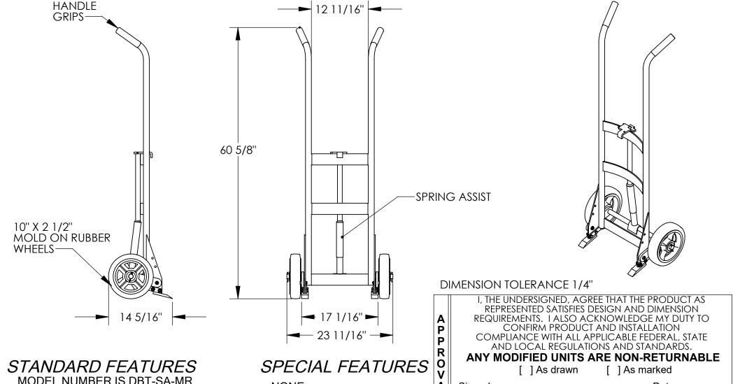
MODEL NUMBER IS DBT-SA-MR CAPACITY: 1,000 LBS **OVERALL WIDTH IS 23 11/16" USABLE WIDTH IS 17 1/16" OVERALL LENGTH IS 14 5/16" OVERALL HEIGHT IS 60 5/8"** SPRING LOADED AXLE Ø10" X 2 1/2" MOLD ON RUBBER WHEELS FOR USE WITH STEEL DRUMS ONLY TOUGH BAKED IN POWDER COATED YELLOW FINISH
